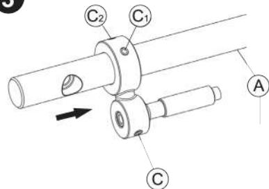
Надеть упоры на штангу А и зафиксировать винтами С1 и С2. Для смены стопора с правого на левый использовать винт С.
