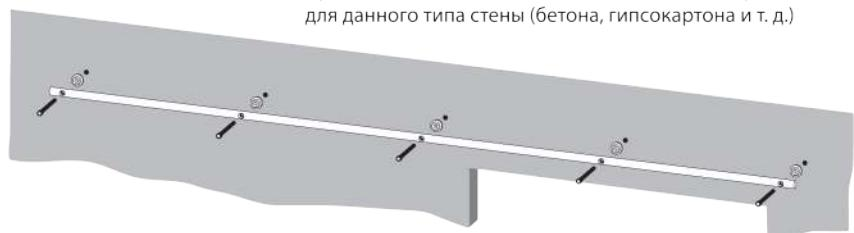
Разметить и просверлить отверстия в стене под установку направляющей штанги. Штанга крепится к стене 5 болтами. При монтаже необходимо использовать дюбели, рекомендованные для данного типа стены (бетона, гипсокартона и т. д.)
