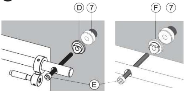
Прикрепить штангу к стене посредством винтов Е. Шайбы D ставятся по краям штанги а шайбы F ставятся в центре. При необходимости увеличить расстояние между дверью и стеной применяется шайба 7 (например при наличии плинтуса, который мешает движению полотна). Шайба приобретается отдельно.
