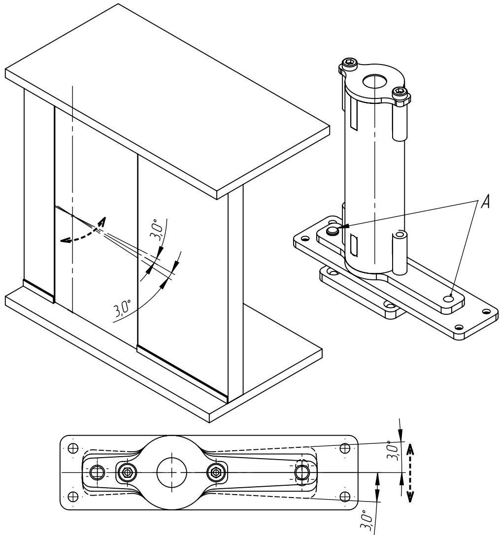
Ослабив болты А можно варьировать угловое положение нижнего узла поворотной системы в диапазоне +3 град для регулировки относительно плоскости стены.
