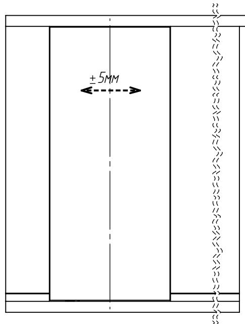
Вращением винта В верхнего узла петли можно отрегулировать отклонение дверного полотна от вертикали в плоскости стены, параллельной лицевой стороне проема. Диапазон регулировки 10мм.
